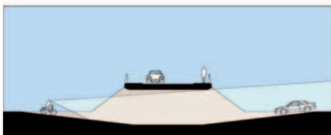
Goede zichtlijnen door de tunnel
